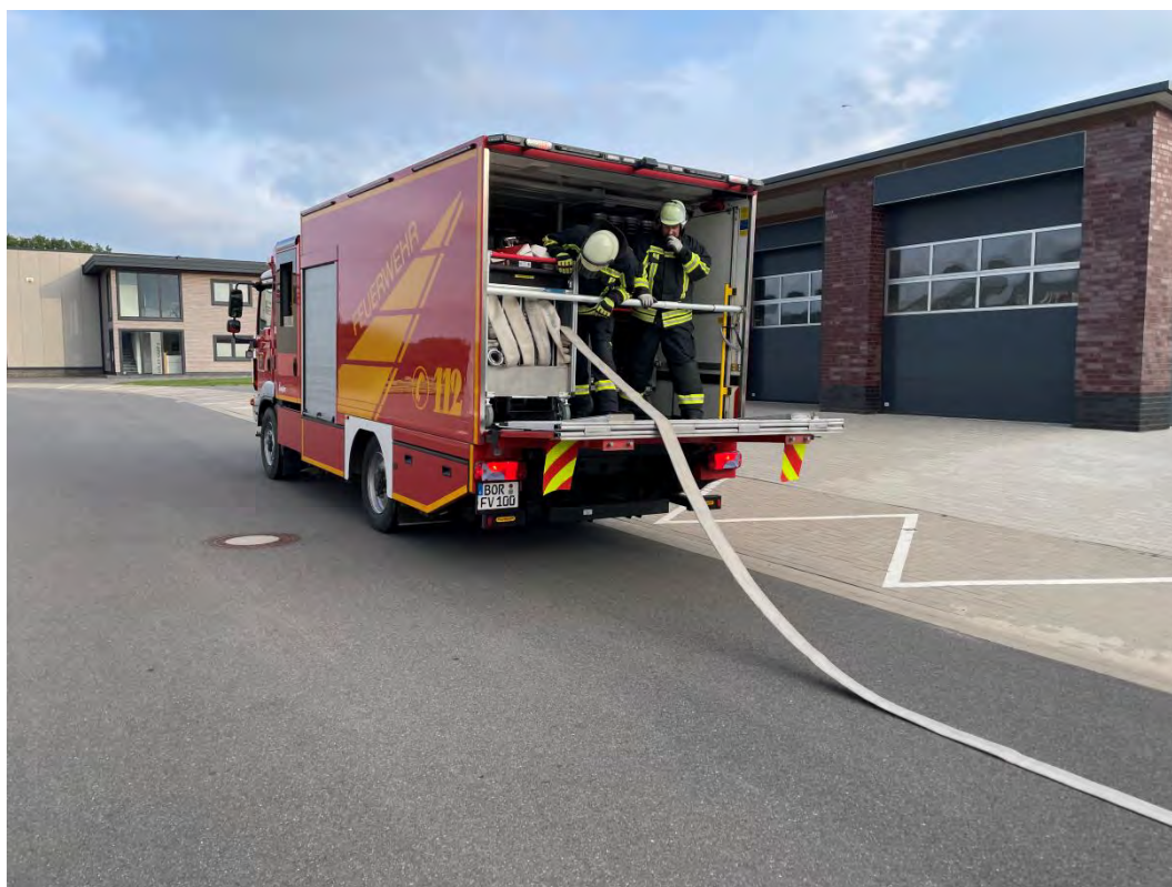
Abb. 7.4-2: LF 20 KatS mit Ladebordwand beim Schlauchverlegen (Foto: Vilain)
